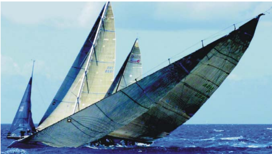
Slika 8. Nagib maxi jedrilice uzrokovan djelovanjem nagibne kobilice na zavjetrinskoj strani, [5, str. 36]
