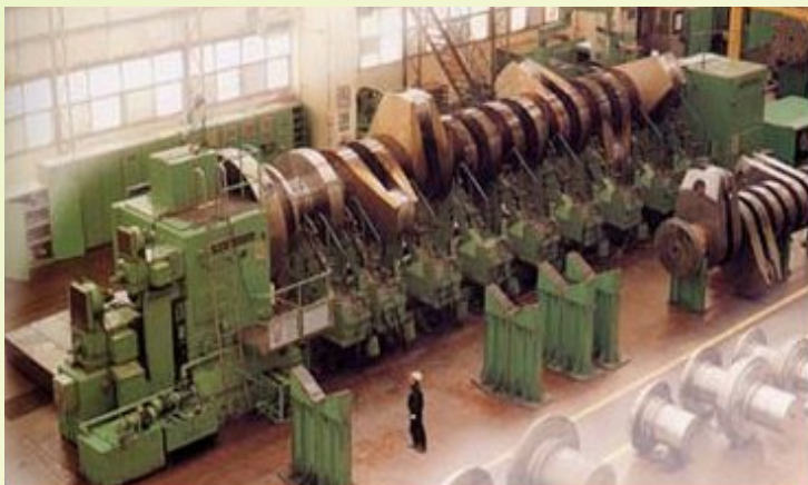
Sastavljeno koljenasto vratilo u završnoj obradi Po čovjeku uz stroj može se ocijeniti dimenzije koljenastoga vratila
