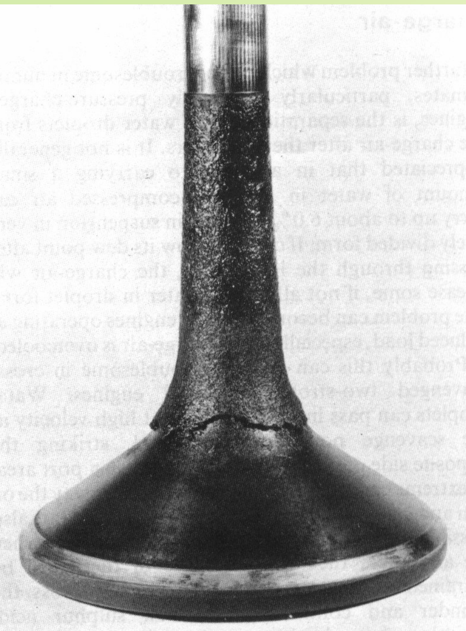
Stvaranje naslaga na usisnim ventilima i u usisnim kanalima
