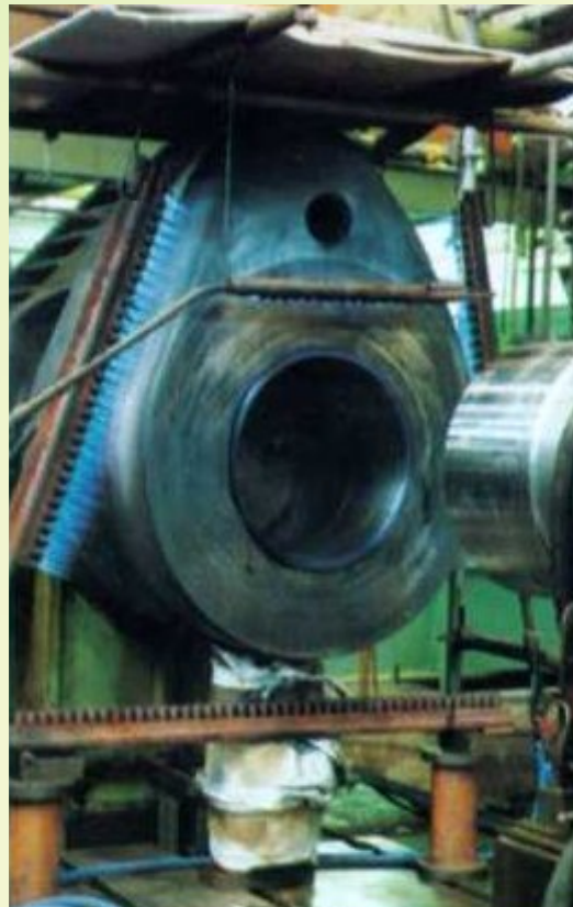
Zagrijavanje koljena plinskim plamenom prije spajanja koljena i glavnog rukavca
