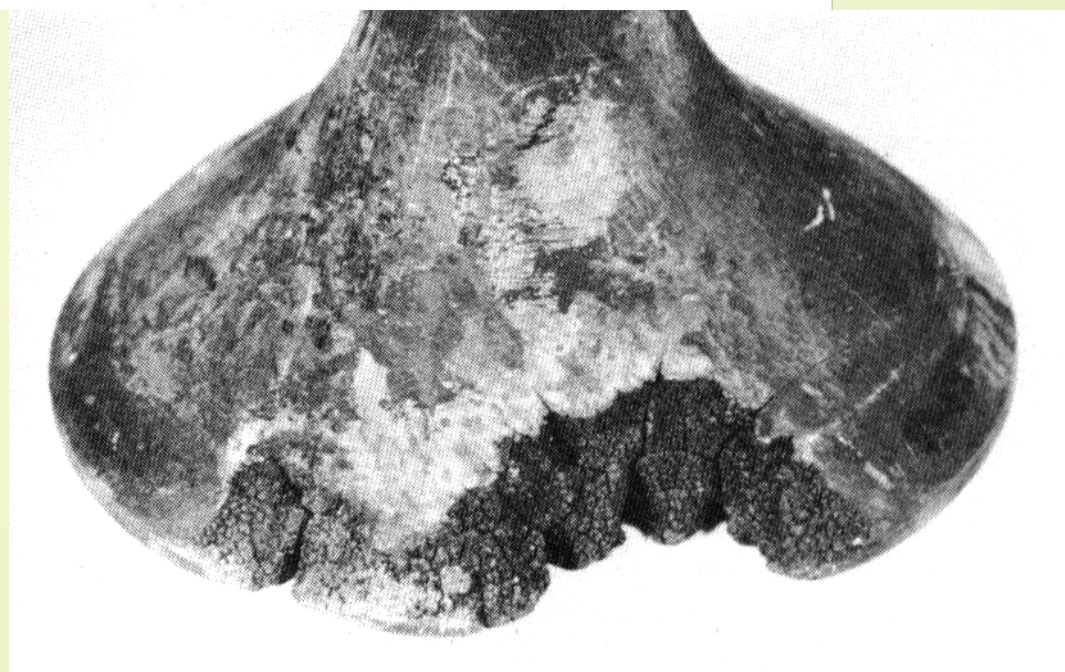
Oštećenja sjedišta ventila zbog djelovanja visokotemperaturne korozije
