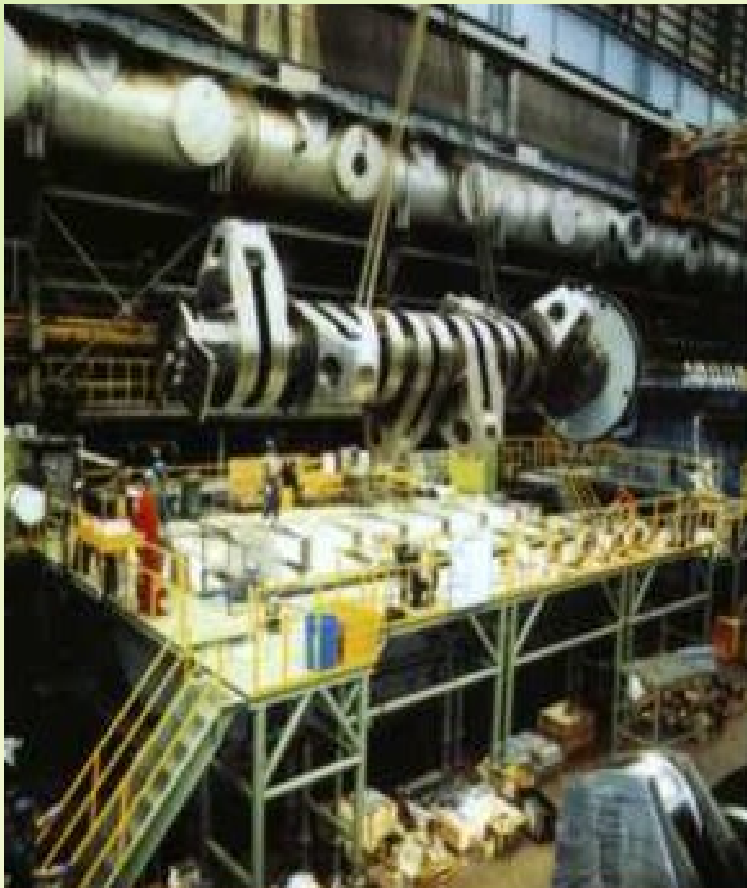
Spuštanje koljenaste osovine u ležajeve u temeljnoj ploči motora
