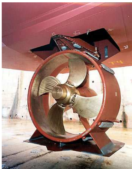
Slika 8. Propeler u sapnici: l – duljina sapnice, D_p – vanjski promjer propelera, D_i – najmanji unutarnji promjer sapnice, D_e – upadni promjer [8]
